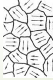
A 鐵磁材料磁田雜亂列
